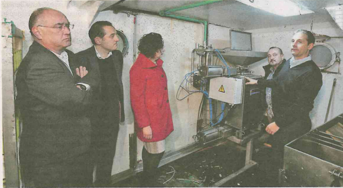
Demostración del funcionamiento del equipo que calienta las tripas para destruir el anisakis. X. RAMALLAL
